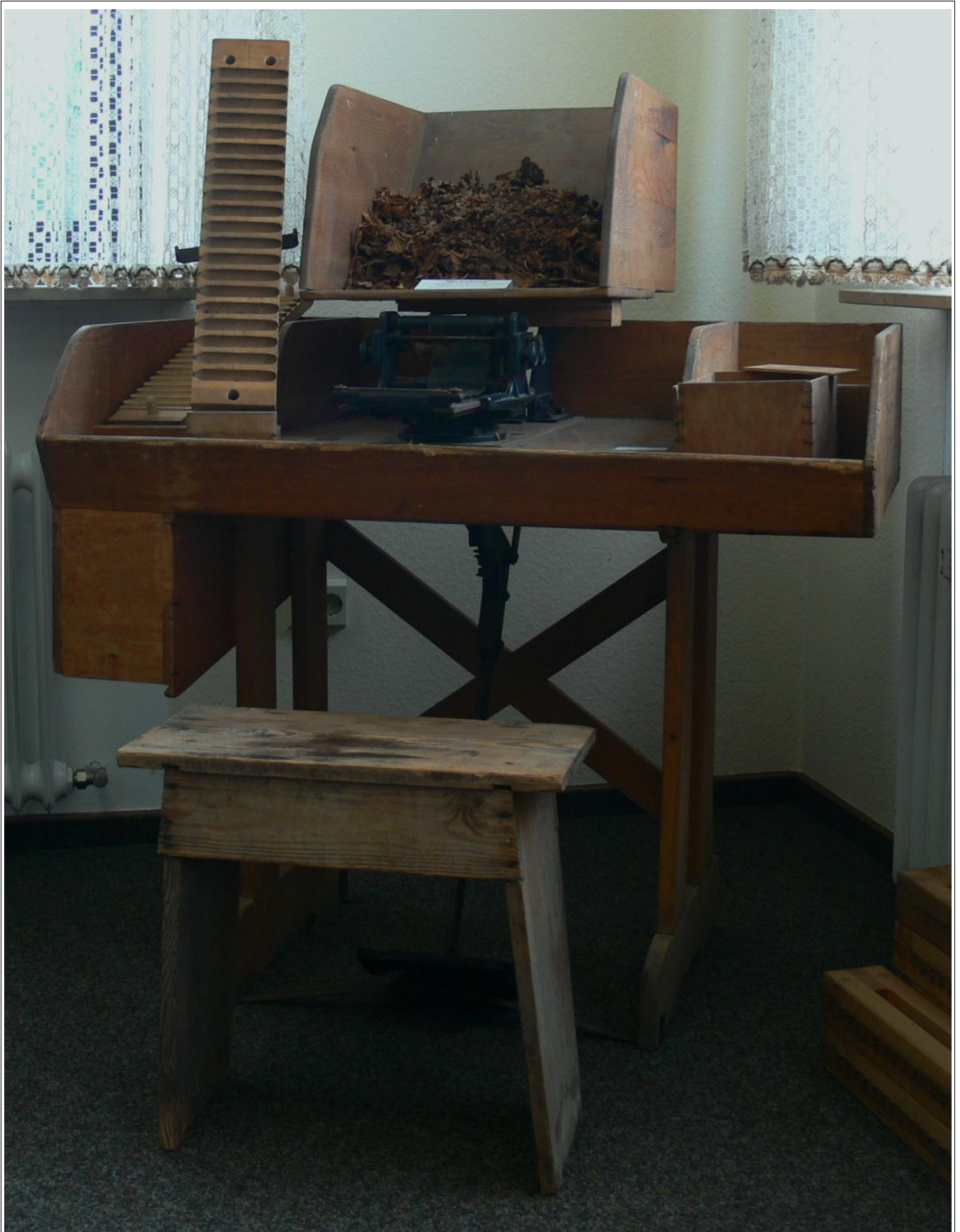
Bild 51: Fußbetriebener Wickelbock zur mechanisierten Herstellung von Wickel und Stumpen.
