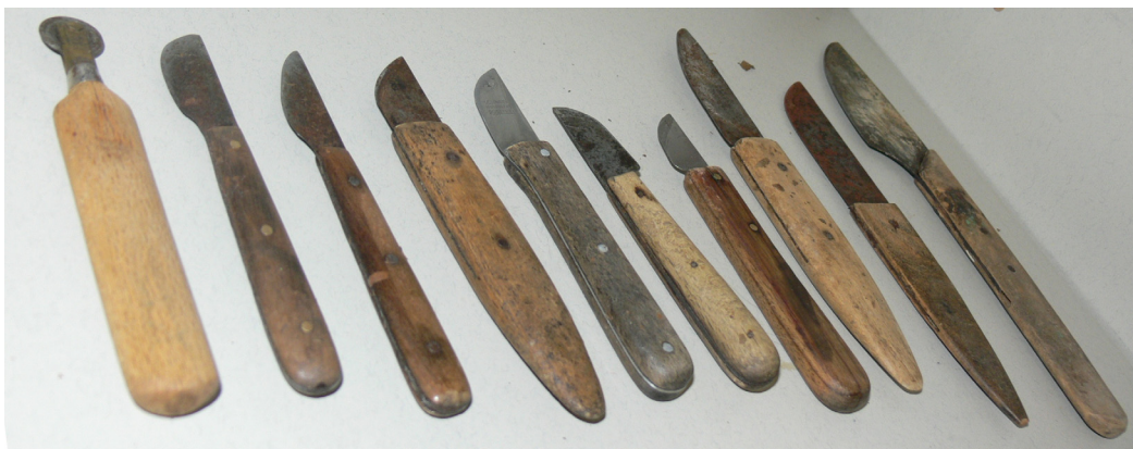
Bild 48: Messersortiment: Die großen Messer dienen zum Abschneiden von aus der Wickelform überstehendem Tabak, die kleineren zum Zuschneiden der Deckblätter. Geschnitten wird auf einem zinkbeschlagenem Brett (aus hygienischen Gründen wird kein Holzbrett verwendet)
